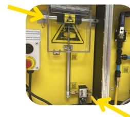
Insérer ensuite la tige et puis le cadenas dans le trou pour sécuriser la source d'énergie.
